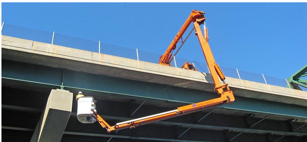
Рис. 1. Специальное оборудование для обследования мостового сооружения
