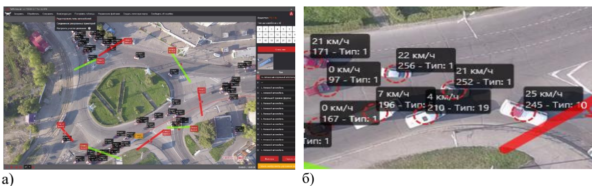
Рис. 2. Окна программы TrafficData Air с результатами обработки: а) восстановление траекторий и корректировка состава; б) визуализация параметров транспортных потоков.
