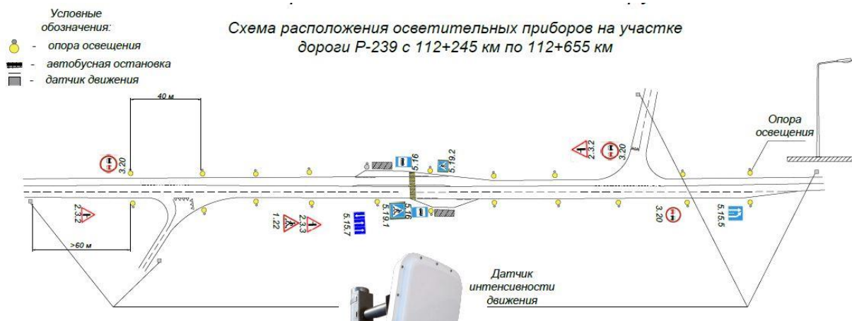
Рис. 4. Схема расположения осветительных приборов на 112 км ФАД «К-О»
