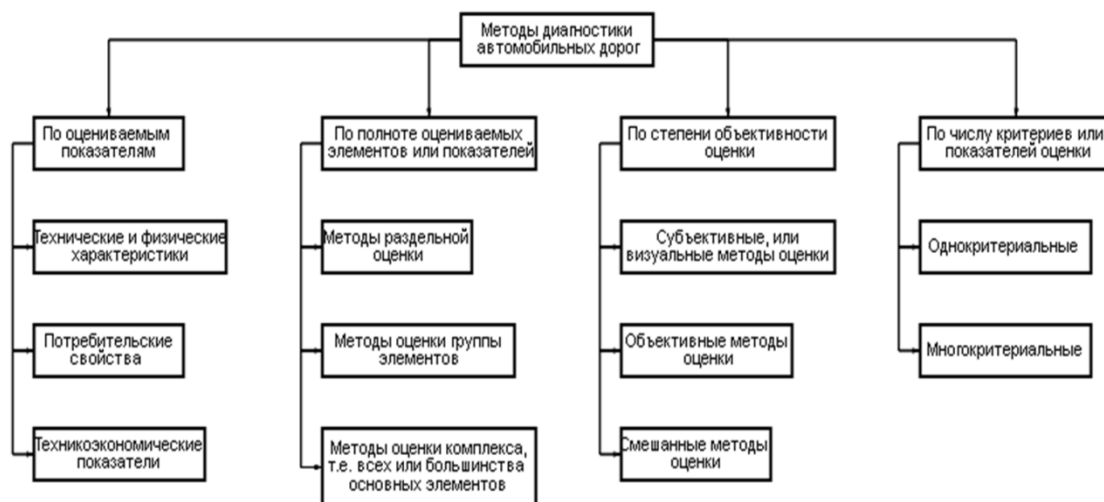
Рис. 3. Методы оценки состояния дорожного полотна
