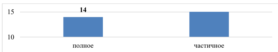
Рис. 10. Распределение аварийных случаев повреждения балконов по степени обрушения
