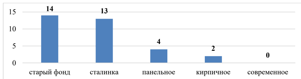
Рис. 4. Распределение аварийных случаев повреждения балконов по типам зданий
