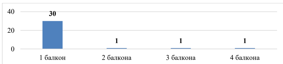
Рис. 8. Распределение аварийных случаев по количеству одновременно поврежденных балконов
