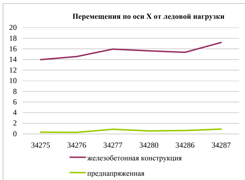
Рис. 7. Сравнение конструкций по перемещениям в узлах при действии ледовой нагрузки
