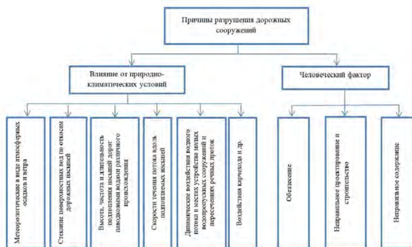
Рис. 5. Основные причины разрушения дорожных сооружений во Вьетнаме
