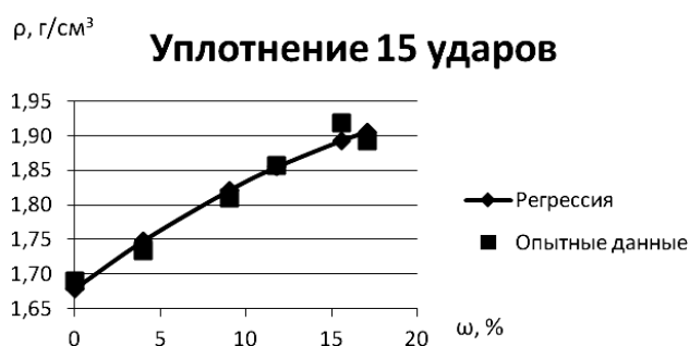
Рис. 2. Зависимость плотности от влажности при 15 ударах уплотнения
