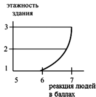
Рис. 4. Оценка в баллах поэтажной реакции людей в здании при Газлийском землетрясении ( T_{\text{соб. кол}} = 0,25 с), г. Самарканд, 3-этажное каркасное здание казармы (курсанты)
