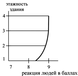
Рис. 3. Оценка в баллах поэтажной реакции людей в здании при землетрясении ( T_{\text{соб. кол}} = 0,18 с), г. Кайраккум, 4-этажное крупнопанельное жилое здание
