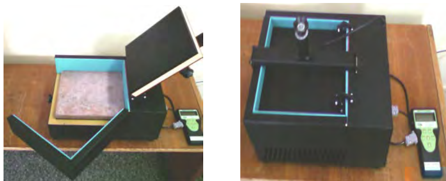
Рис. 2. Фото экспериментальной установки по определению коэффициента теплопроводности \lambda и термического сопротивления R
