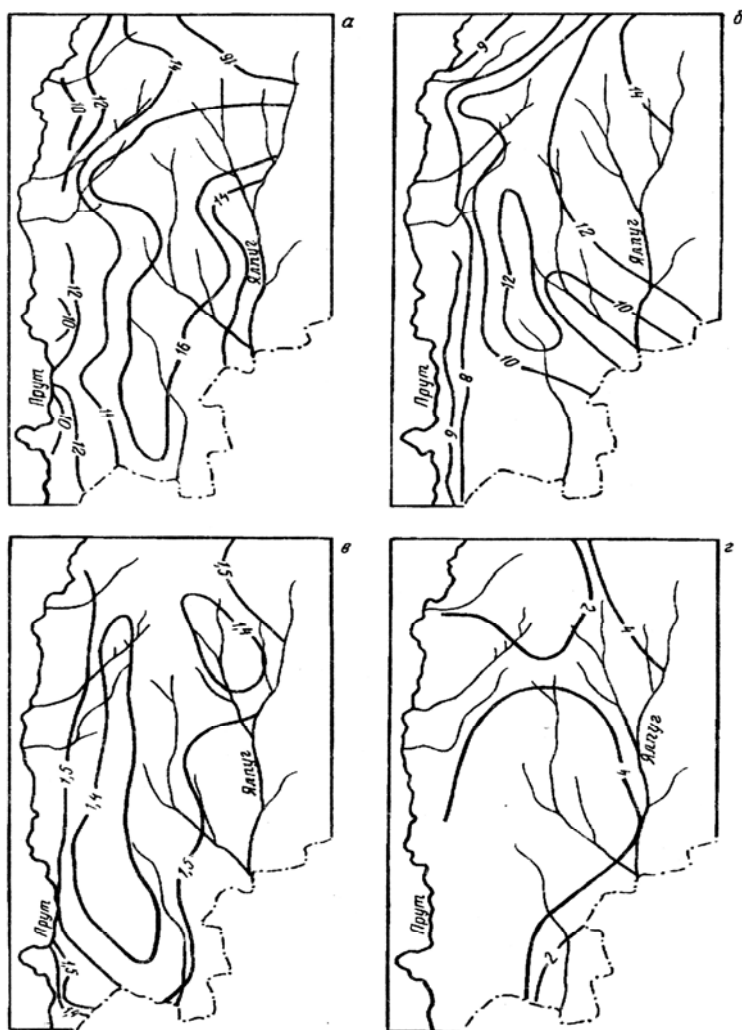
Рис. 3. Карты полей показателей свойств лессовых пород междуречья Прут — Ялпуг: а — природная влажность, %; б — число пластичности, %; в — плотность «сухого» грунта, г/см³; г — относительная просадочность ( \epsilon_{sl} \cdot 10^3 ) при нагрузке 0,3 МПа
