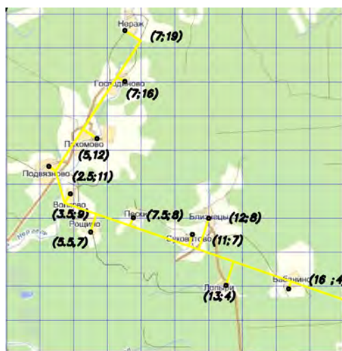
Рис. 3. Оптимальная трассировка межпоселкового газопровода
