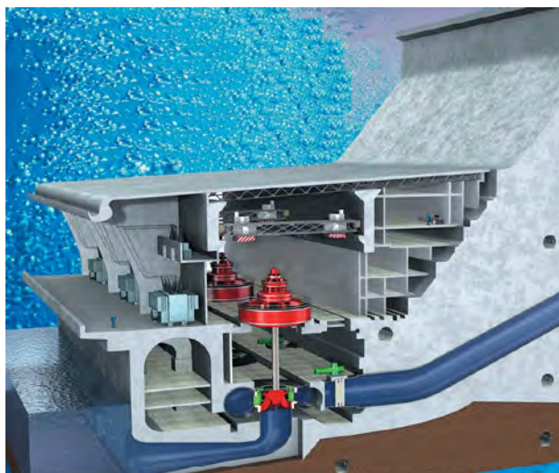
Рис. 1. Схема решетчатого покрытия машинного зала ГЭС (обложка журнала ANSYS Advantage. 2011. № 15)
