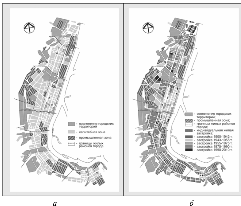
Рис. 1. Структурно-типологический анализ массовой жилой застройки г. Волгограда: а — схема функционального зонирования; б — схема зонирования жилой территории по времени застройки
