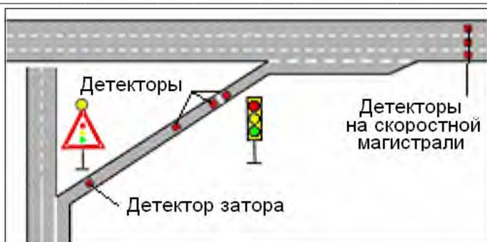
Рис. 5. Обустройство регулируемого примыкания для «дозирования» интенсивности въезда на магистраль [6]
