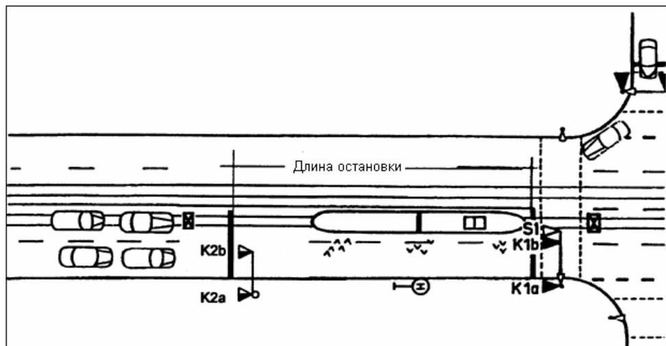
Рис. 4. Обеспечение безопасного перехода проезжей части при посадке/высадке пассажиров на трамвайной остановке, расположенной на середине проезжей части [6]
