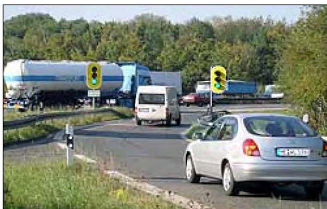
Рис. 6. Регулируемое примыкание для «дозирования» количества въезжающих автомобилей на автомагистраль в Германии [6]
