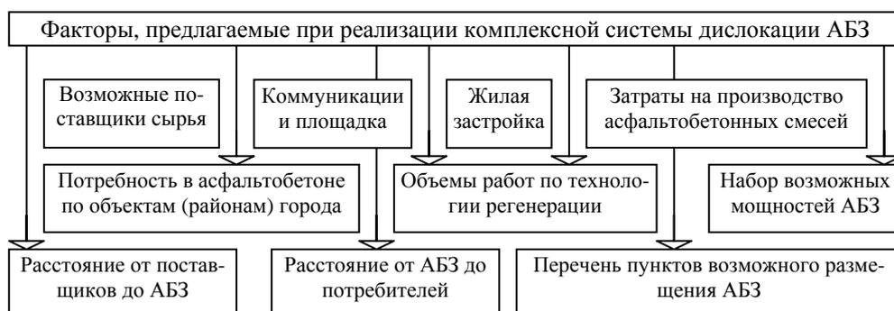
Рис. 2. Схема факторов, предлагаемых при построении системы оптимизации дислокации и мощности городских АБЗ
