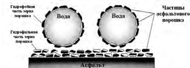
Рис. 1. Схема стабилизации водных глобул частицами асфальтового порошка
