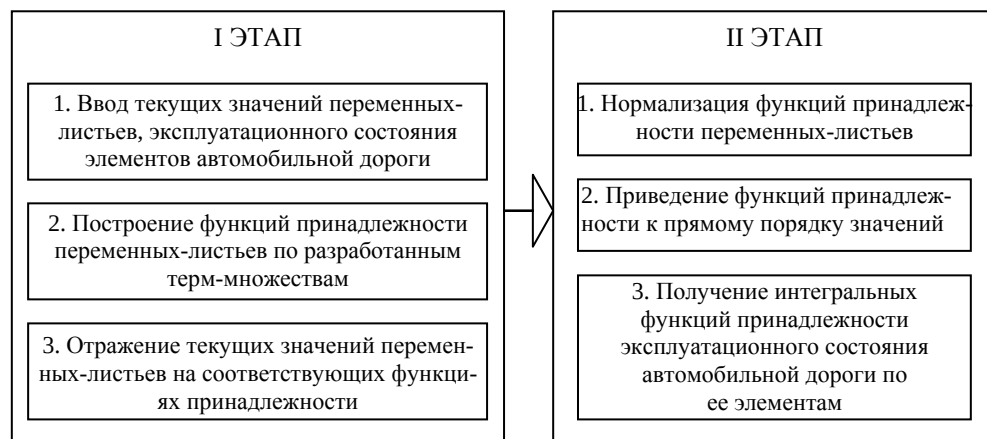
Рис. 1. Концептуальная схема работы модели оценки эксплуатационного состояния автомобильных дорог с учетом информации качественного характера
