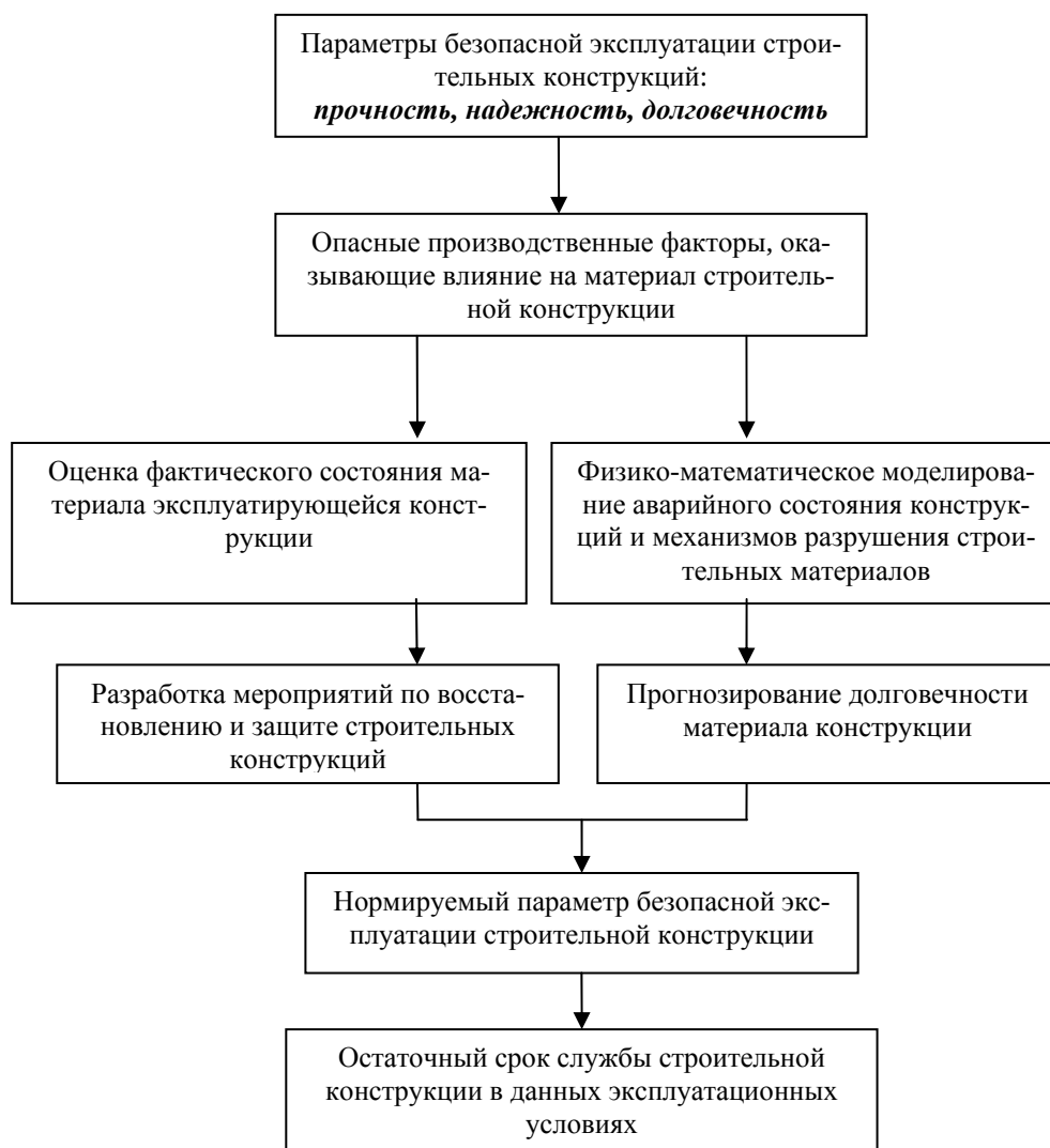
Рис. 1. Основные принципы обеспечения безопасности эксплуатируемых элементов конструкций
