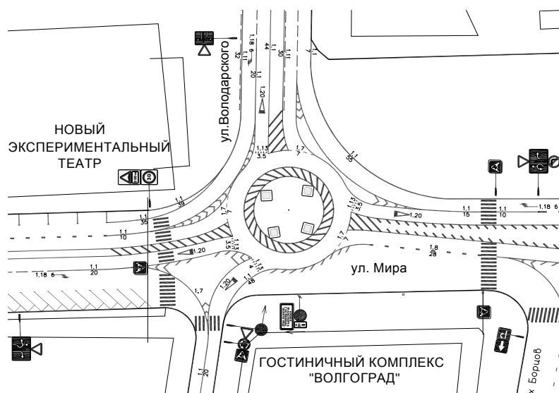
Рис. 4. Пример модернизации автомобильных дорог средствами организации движения без изменения геометрии автомобильных дорог, путем устройства МКП в районе гостиницы «Волгоград»: а — фото условий движения до устройства МКП; б — схема организации движения с устройством МКП
