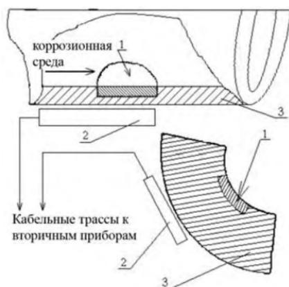
Рис. 4. Образец-свидетель, вплавленный в стенку технологического аппарата: 1 — образец-свидетель с радионуклидной меткой; 2 — детектор  $\gamma$ -излучения; 3 — стенка технологического аппарата (сооружения)
