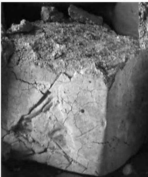
Рис. 3. Образец из высокопрочного бетона после воздействия пожара
