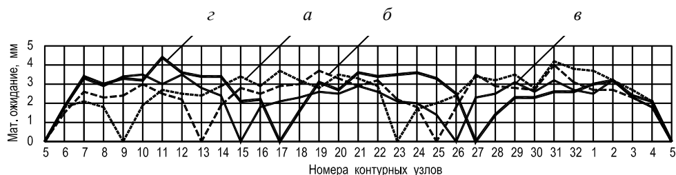
Рис. 3. Графики изменения математических ожиданий отклонений контурных узлов для разных схем начального опирания
