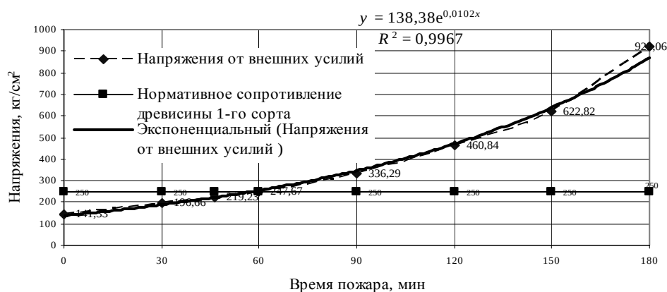
Рис. 7. Изменение напряжений от внешних усилий в деревянной стойке стеновой панели Н4 во время пожара
