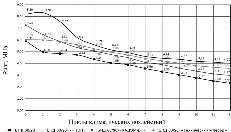
Рис. 2. Изменение прочности асфальтобетона на растяжение при изгибе при температуре 0^{\circ}\text{C} и скорости плиты пресса 50 мм/мин
