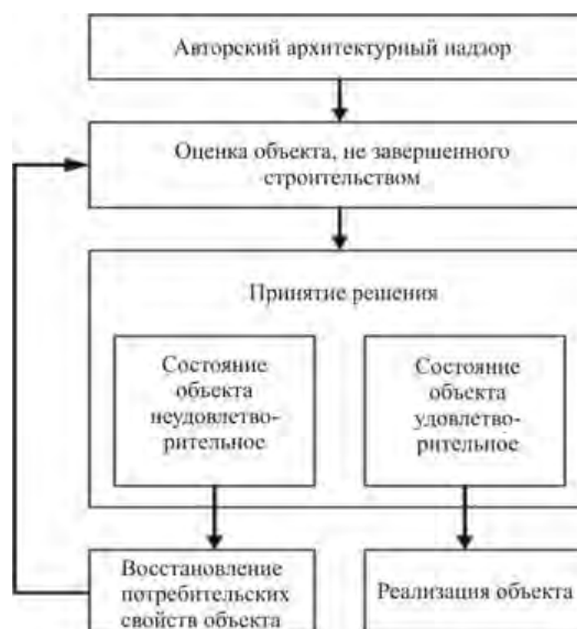
Вариант схемы принятия решения о дальнейшем использовании объекта, не завершеного строительством
