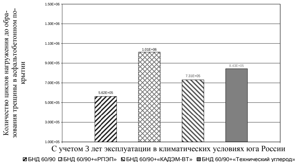
Рис. 5. Количество циклов нагружения до образования трещин в асфальтобетоне покрытия, эксплуатируемого в IV дорожно-климатической зоне
