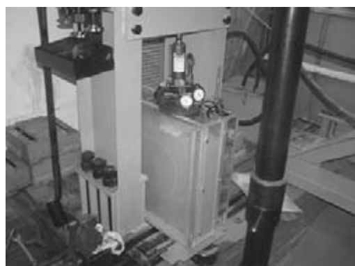
Рис. 2 (вверху). Общий вид испытательной установки: нагружение проводится гидравлическим домкратом, измерение усилия — динамометром ДС-5, измерение деформаций — индикаторами часового типа
