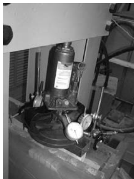
Рис. 3 (справа). Схема расположения измерительных приборов и нагружающего устройства на экспериментальной установке
