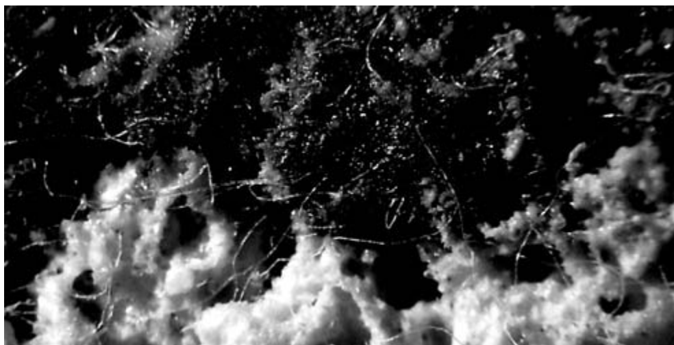
Рис. 1. Структура поверхности бокового среза образца с полимерным покрытием
