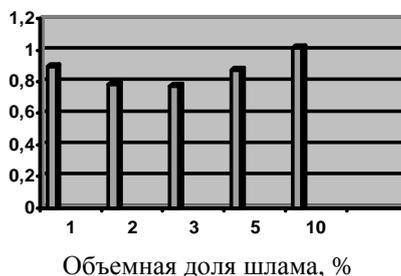
Рис. 4. Средняя плотность образцов после обжига в зависимости от содержания шлама
