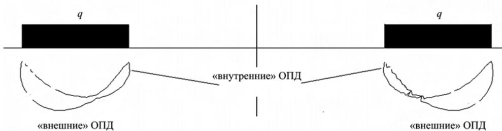
Рис. 6. Слияние «внешних» и «внутренних» областей пластических деформаций при ослаблении взаимного влияния фундаментов
