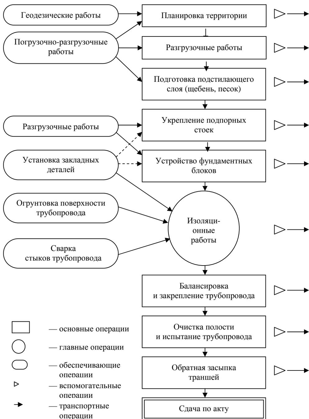
Рис. 1. Схема устройства линейно-протяженного объекта (трубопровода)
