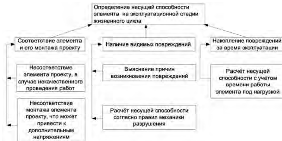
Рис. 2. Алгоритм проведения обследования при оценке эксплуатационной несущей способности R_{ser}
