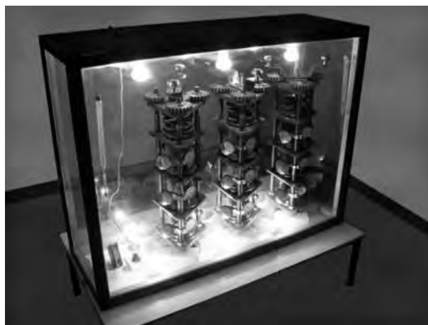
Рис. 1. Прибор для определения ползучести асфальтобетона
