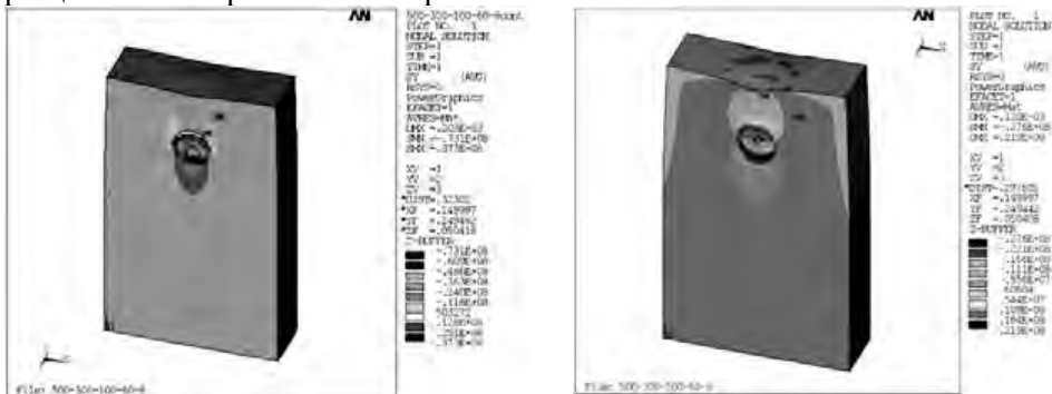
Рис. 3. Изополя напряжения образца \sigma_y (напряжения смятия): a — серия «C»; б — серия «J»
