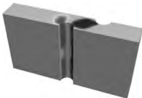
Рис. 4. Поперечные перемещения грунта в массиве (IV стадия)
