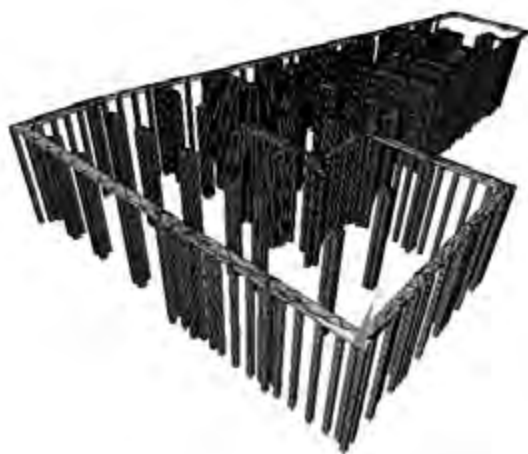
Рис. 3. Свайное поле с ростверком
