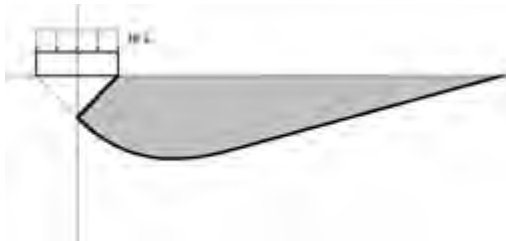
Рис. 6. Тотальные призма выпора и полоса скольжения при нагрузке № 4
