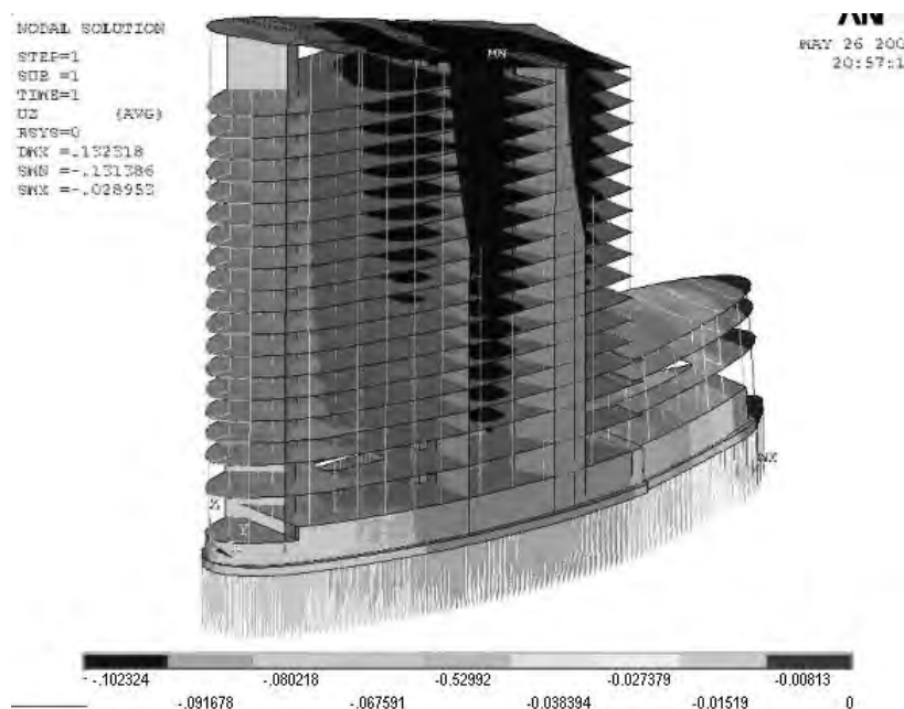
Рис. 4. Перемещения вдоль вертикальной оси Z
