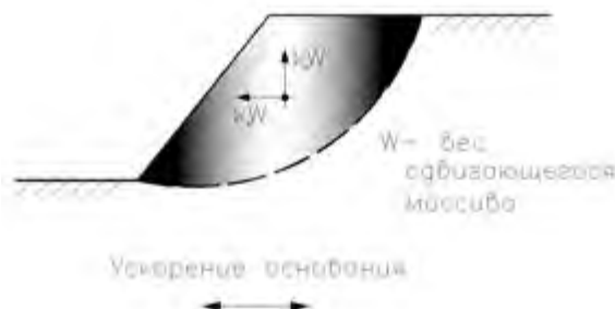
Рис. 1. Псевдостатический МПР для сейсмической нагрузки
