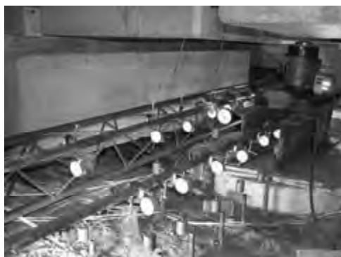
Рис. 1. Общий вид круглого штампа и измерительных устройств
