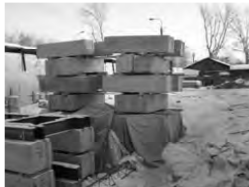
Рис. 2. Нагружающая система из фундаментных блоков
