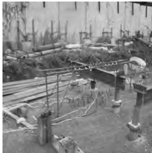
Рис. 4. Статическое испытание микропай
