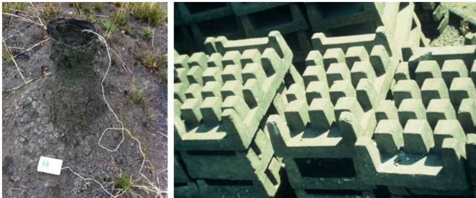
Рис. 5. Измерение температуры термитных курганов (слева) и модель гетерогенной структуры фасада (справа) [19]
