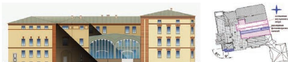
**Рис. 4.** Окончательный проект размещения фотоэлектрических панелей на проектируемом остеклении внутреннего двора
