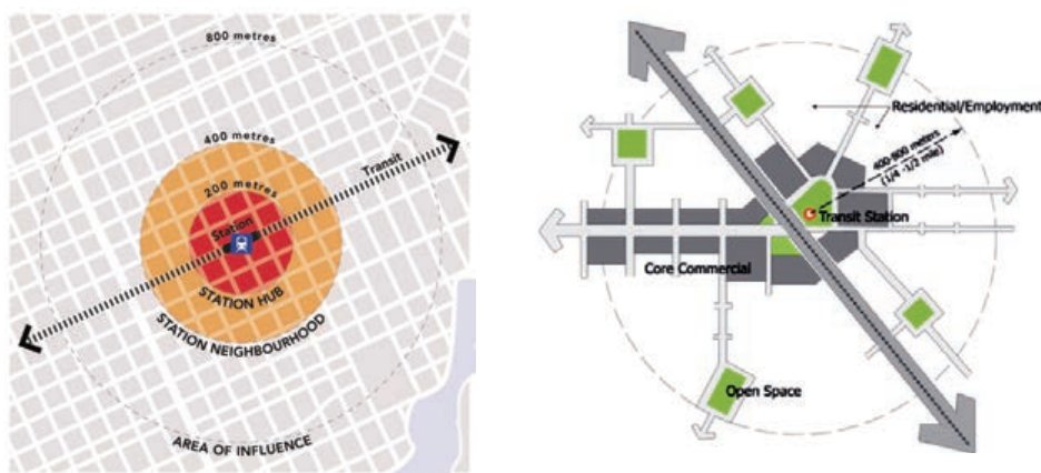
Рис. 2. Схемы ТОД-районов, показывающие зоны влияния транзитного центра/станции на окружающую территорию. (Источники: http://www.somervillebydesign.com/wp-content/uploads/2013/08/TOD_Diagram.jpg ; http://blog.2030palette.org/swatch-profile-transit-oriented-development/ )
