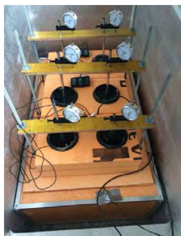
Рис. 2. Прибор для определения степени пучинистости грунтов
