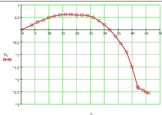
Рис. 9. График перемещений в месте установки прогибомера (точка 1)
