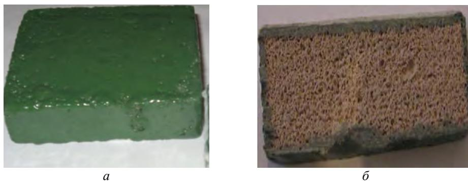
Рис. 7. Образец для антикоррозионных испытаний: *a* — общий вид; *б* — срез образца
