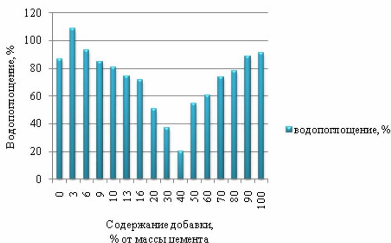
Рис. 4. График зависимости водопоглощения от количества микрокремнезема
