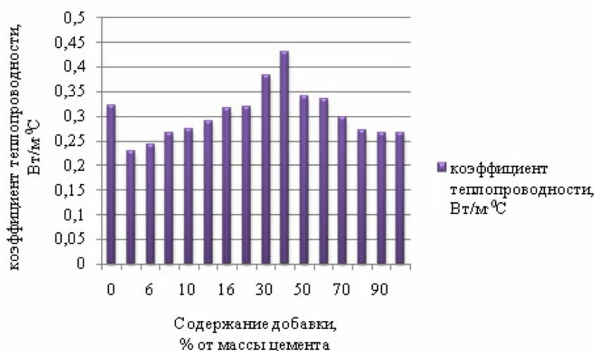
Рис. 3. График зависимости коэффициента теплопроводности от количества микрокремнезема
