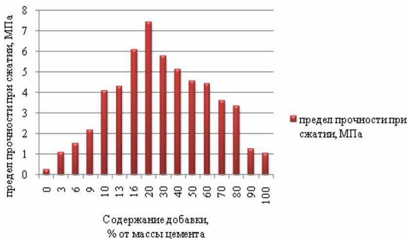
Рис. 2. График зависимости предела прочности при сжатии от количества микрокремнезема
