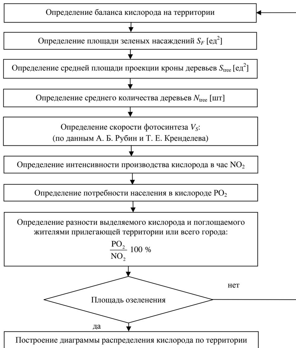
Рис. 3. Блок-схема алгоритма определения кислородного баланса
