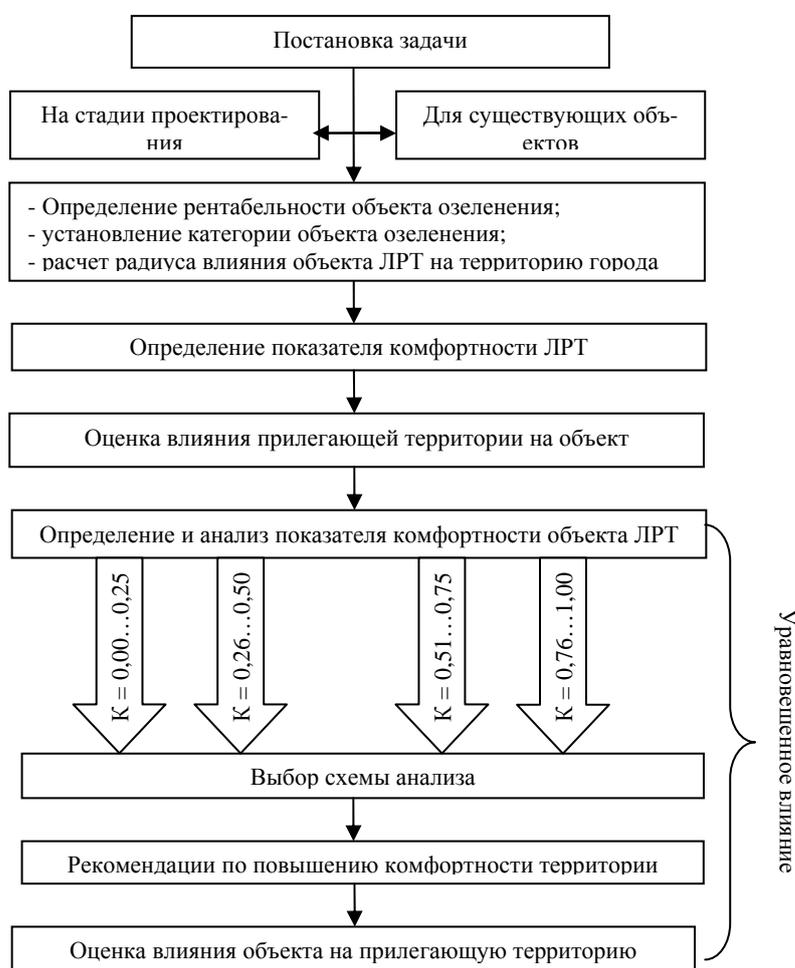
Рис. 7. Блок-схема алгоритма определения показателя комфортности
