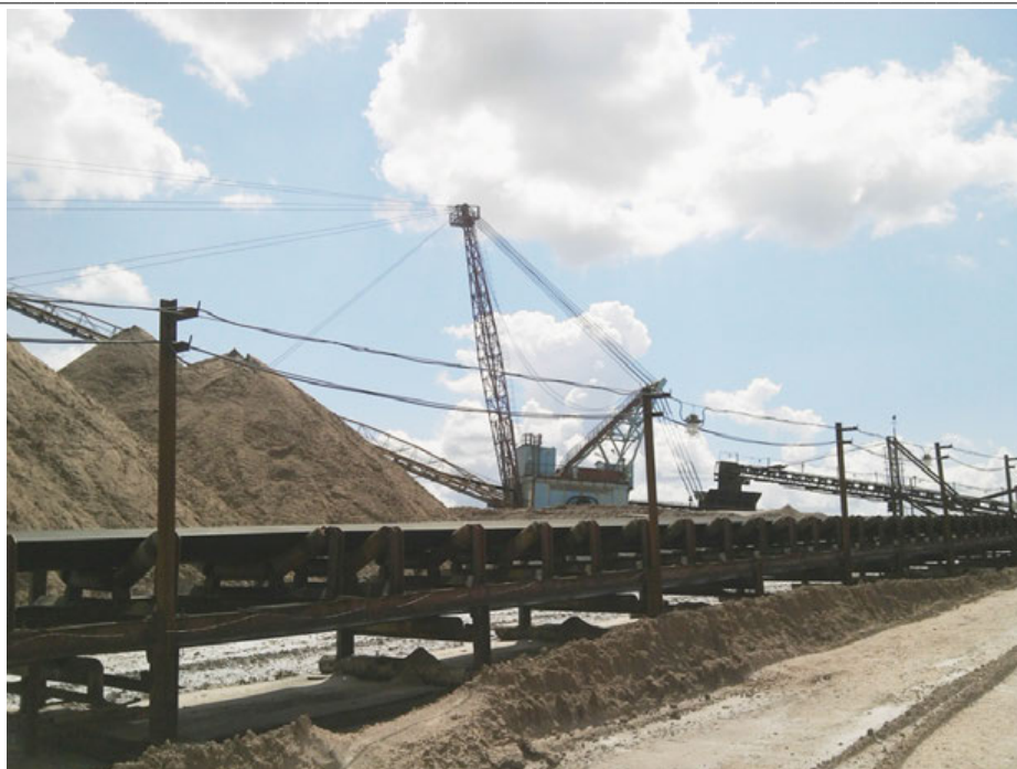
Рис. 3. Конвейерный транспорт и самоходный отвалообразователь на вершине солеотвала
