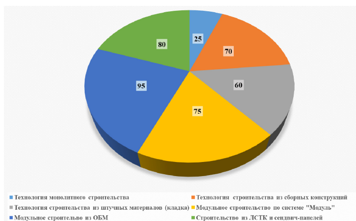
Рис. 3. Преимущества модульного строительства в сравнении с другими строительными технологиями по степени заводской готовности, %, данные по всем технологиям, кроме модульного строительства из ОБМ, соответствуют данным [15] (выполнено авторами)
