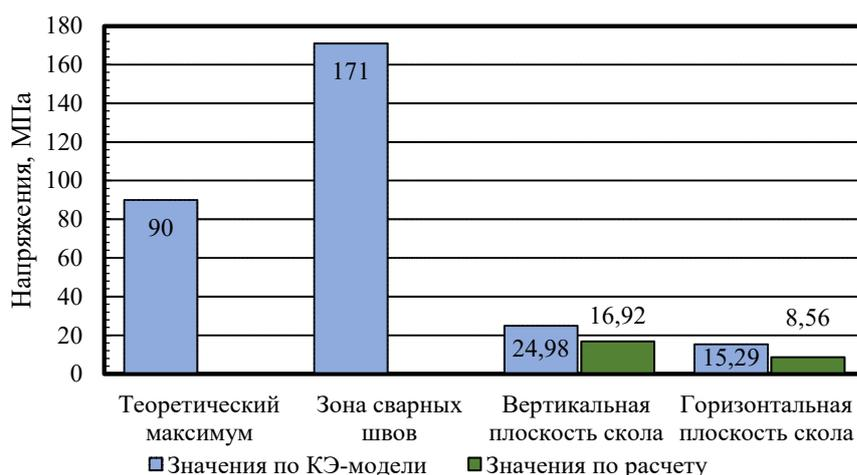
Рис. 8. Сравнение значений напряжений, полученных различными методами
