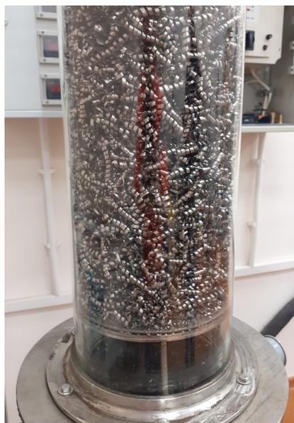
Рис. 1. Экспериментальный модуль с исследуемым насадочным материалом S-BT5<sub>ε-0,85</sub>
