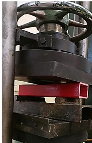
Рис. 6. Испытания элемента на сжатие
