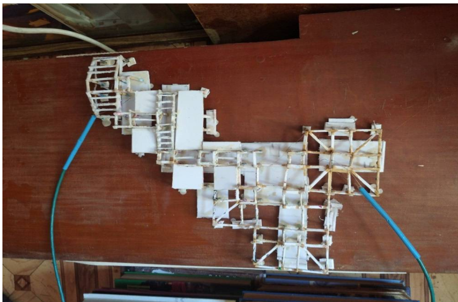
Рис. 2. Каркасная модель (вид сверху) из пластика ABS с парой электродов
