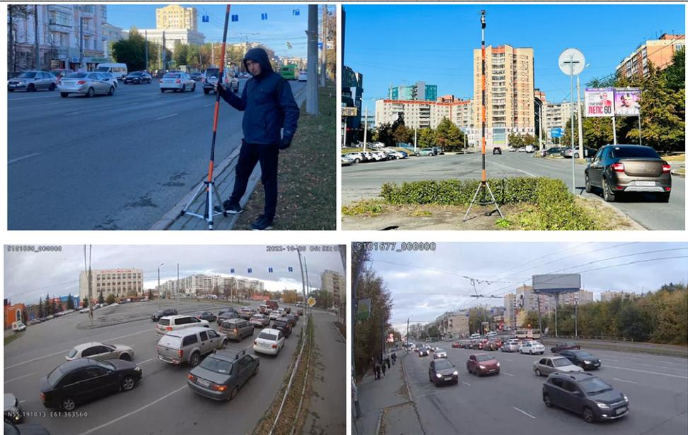
Рис. 6. Проведение натуральных обследований структуры и интенсивности движения автотранспорта путем видеофиксации по видеофайлам
