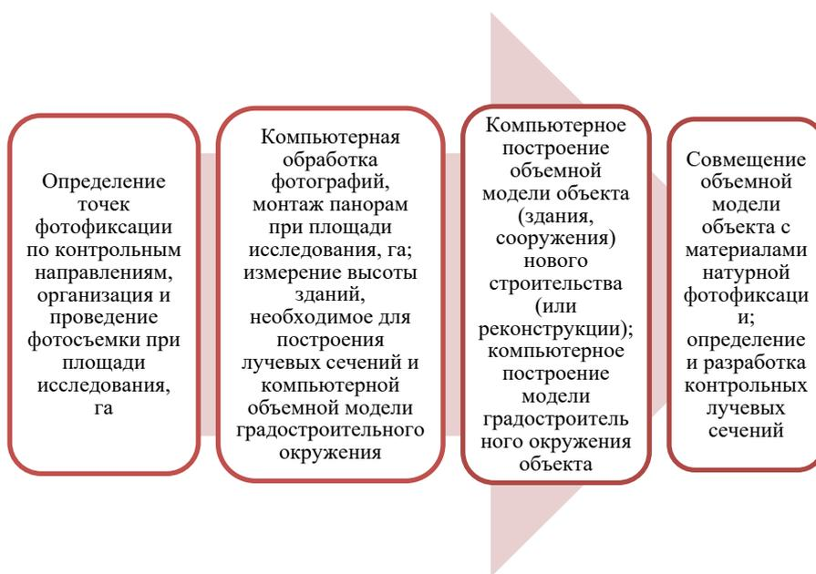
Рис. 7. Компьютерное моделирование развития градостроительной ситуации
