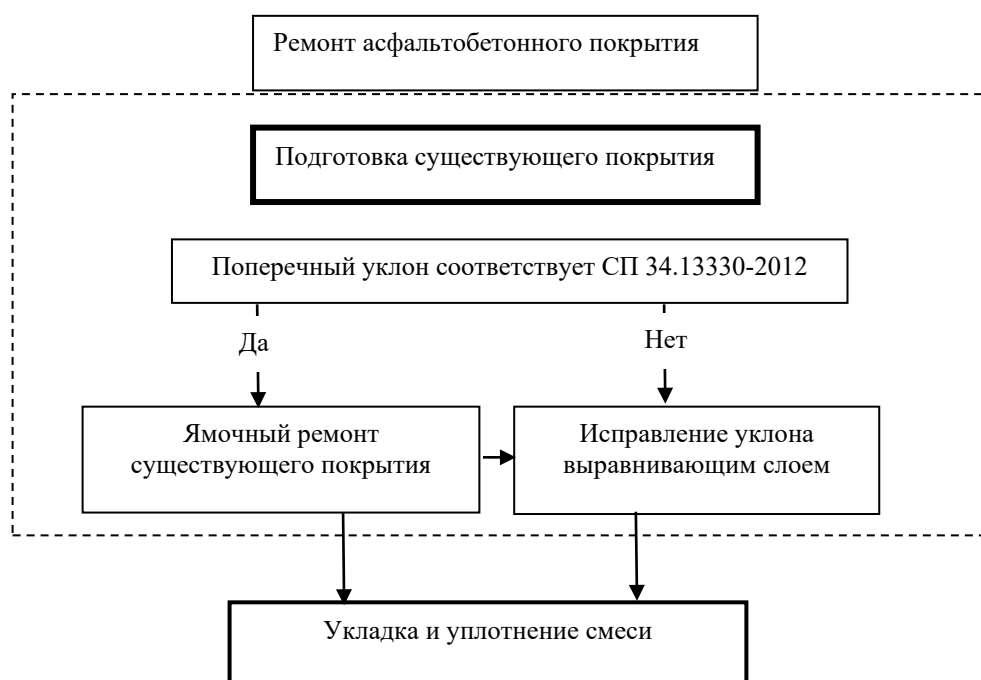
Рис. 1. Блок-схема ремонта асфальтобетонного покрытия
