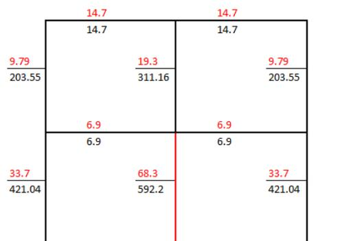
Рис. 14. Значения усилий  $N$ , кН, в двухэтажной этажерке с шарнирным креплением ригеля к колоннам
