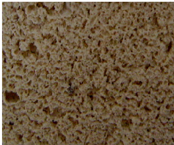
Рис. 2. Структура образца глинисто-шамотной керамики с добавкой шлама металлообработки
