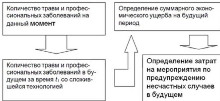
Рис. 2. Алгоритм прогнозирования риска производственного травматизма в строительстве газопроводов
