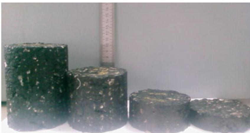
Рис. 2. Образцы ЩМА для определения влияния толщины слоя одежды на прочностные параметры
