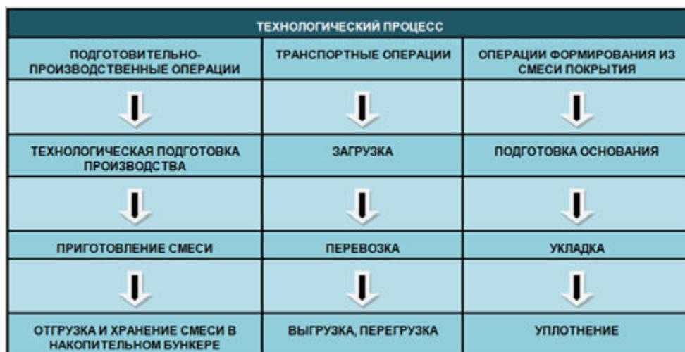
Рис. 1. Структурная схема технологического процесса строительства асфальтобетонного покрытия
