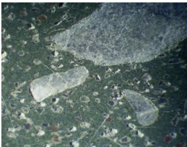
Рис. 3 Микроструктура полимербетона ( $30\times$ )
