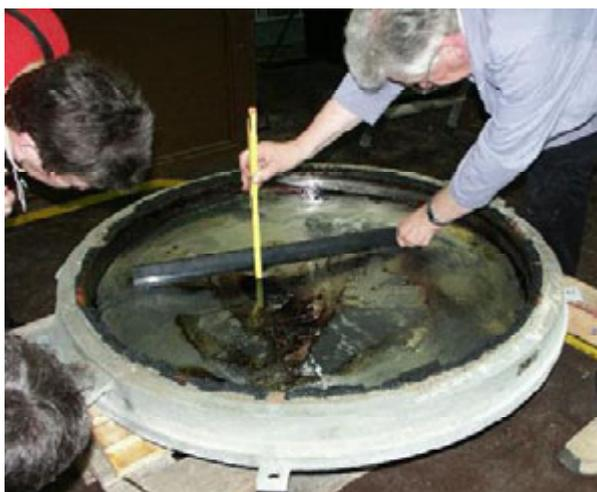
Рис. 3. Данная опорная часть была деформирована более чем на 25 мм из-за неправильного заполнения раствором. Несмотря на это, данная опорная часть выполняла возложенные на нее функции более чем 20 лет
