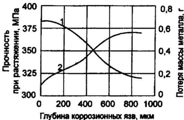
Рис. 2. Зависимости прочности при растяжении арматуры и потери массы металла от глубины коррозионных язв. 1 – прочность при растяжении, 2 – потеря массы металла
