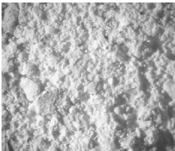
Рис. 1. Структура исходного образца глинисто-шамотной керамики
