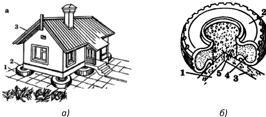
Рис. 6. Фундамент из утилизированных покрышек: а — общий вид дома; б — конструкция фундамента; 1 — утрамбованный грунт основания; 2 — покрышка; 3 — бетонная плита; 4 — песок; 5 — гравий
