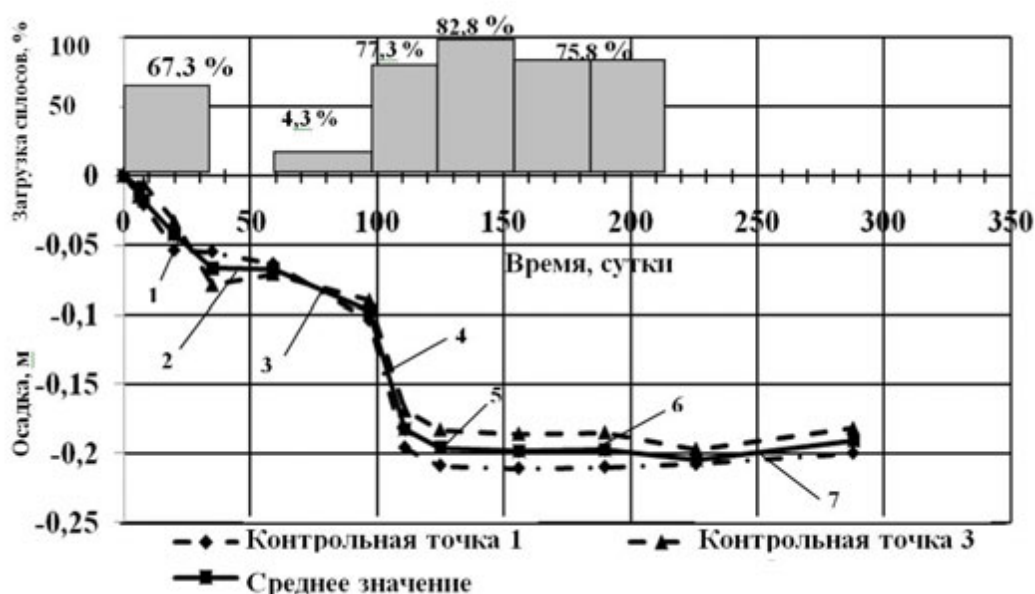
Рис. 3. График развития осадков зернохранилища СМВУ 165.18.В12 №35; 1 – 7 – стадии деформирования; в процентах указана загрузка силоса от проектной
