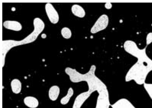
Рис. 2. Микроструктура композиций битума с 5% масс СКЭПТ-Э-30 при 200 и 25°С
