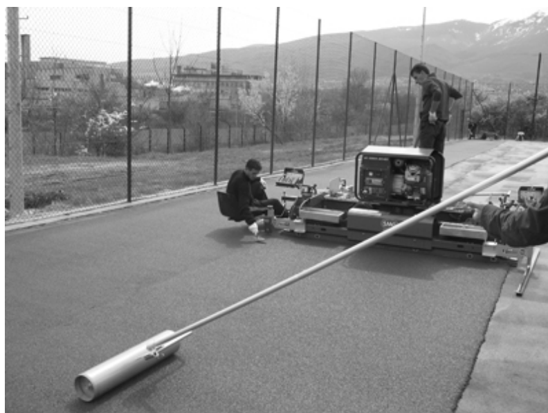
Рис. 2. Автоматизированное устройство для инсталляции синтетических спортивных покрытий и эластичных подложек PlanoMatic P928
