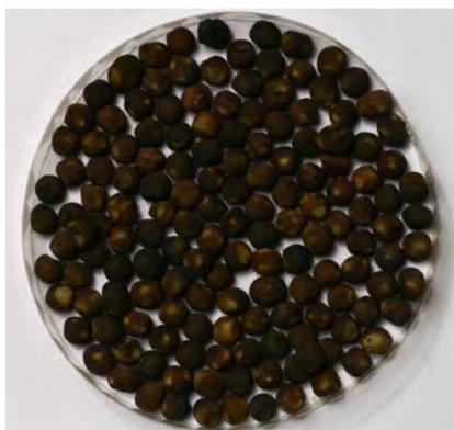
Рис. 2. Катализатор после работы в реакторе с неподвижным слоем
