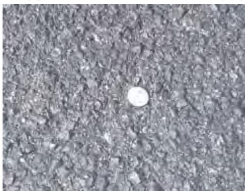
Рис. 3. Структура поверхности свежеложенного ЛЭМС.
