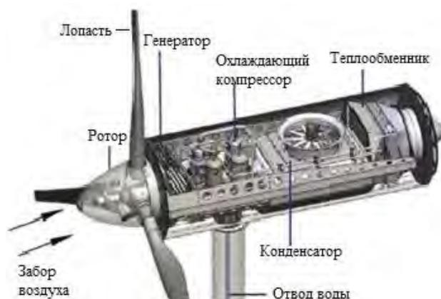
Рис. 1. Структурная схема ветрогенератора Eolewater WMS1000.
