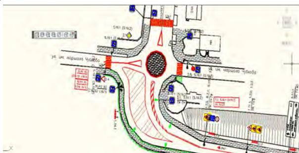
Рис. 2. Схема модернизации пересечения ул. Комсомольской и маршала Чуйкова с использованием мини кольцевого пересечения.
