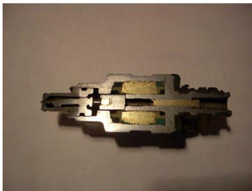
Рис. 1. Препарированный инжектор в сборе.
