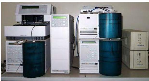
Рис. 1. Высокоэффективный жидкостной хроматограф «Varian Pro Star 500».
