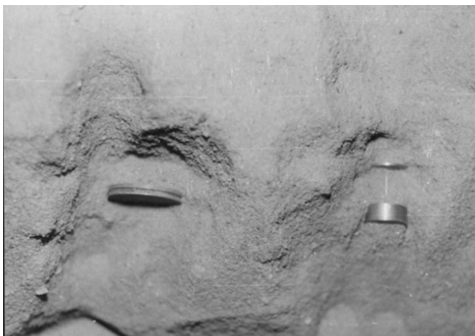
Рис. 2. Положение преобразователей в песчаном основании модели фундамента
