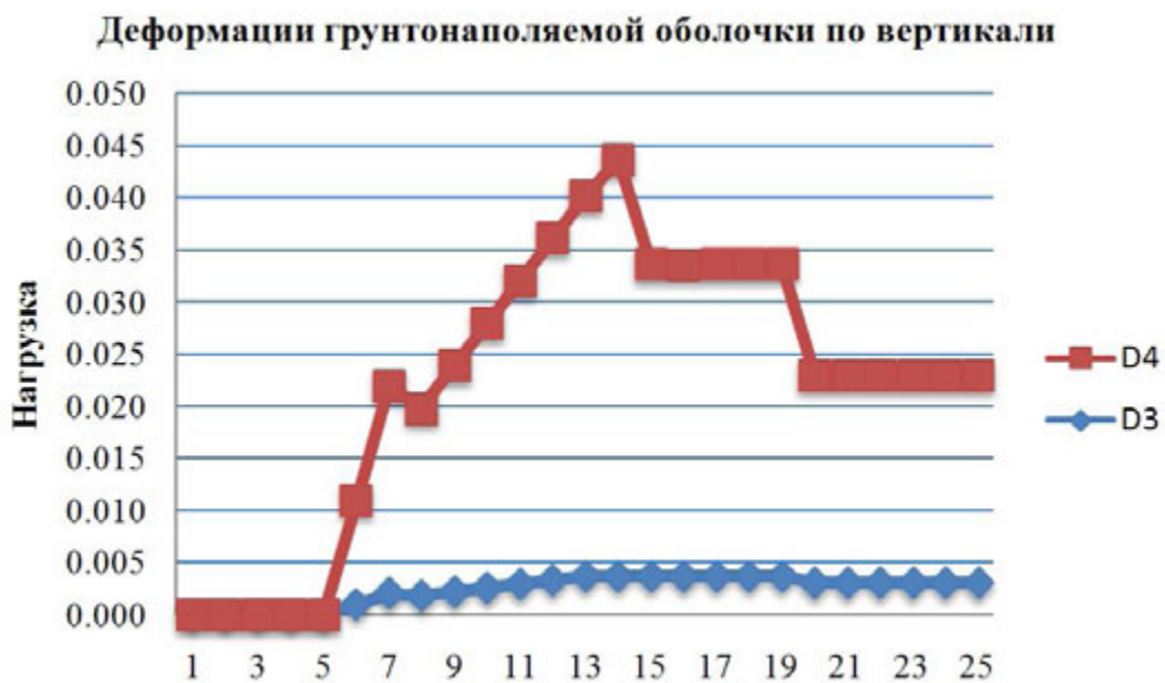
Рис. 3. Графики зависимости деформации грунтонаполняемой оболочки от нагрузки: D1, D2 – деформации в горизонтальном направлении, D3, D4 – деформации в вертикальном направлении
