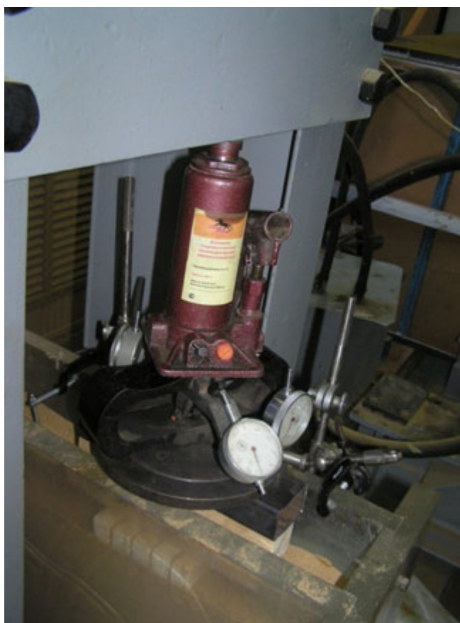
Рис. 3. Схема расположения измерительных приборов и нагружающего устройства на экспериментальной установке
