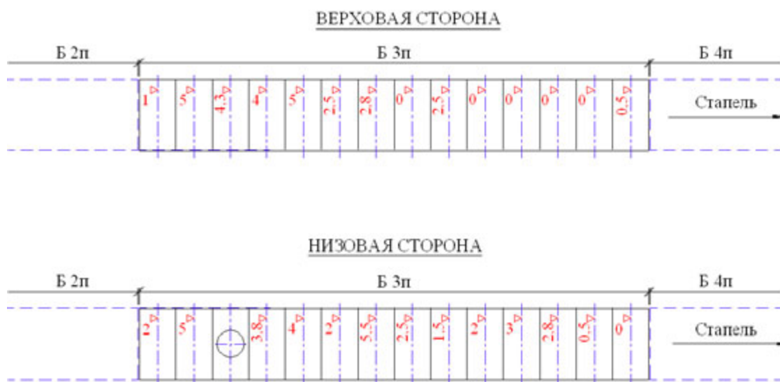
Рис. 2. Результаты измерения амплитуд погибей, нанесенные на схему блока
