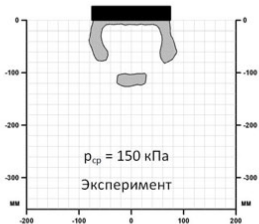
Рис. 2. Развитие зон предельного состояния грунта круглого штампа при среднем давлении: а, г — при p_{cp} = 50 \text{ кПа} ; б, д — при p_{cp} = 100 \text{ кПа} ; в, е — при p_{cp} = 150 \text{ кПа}
