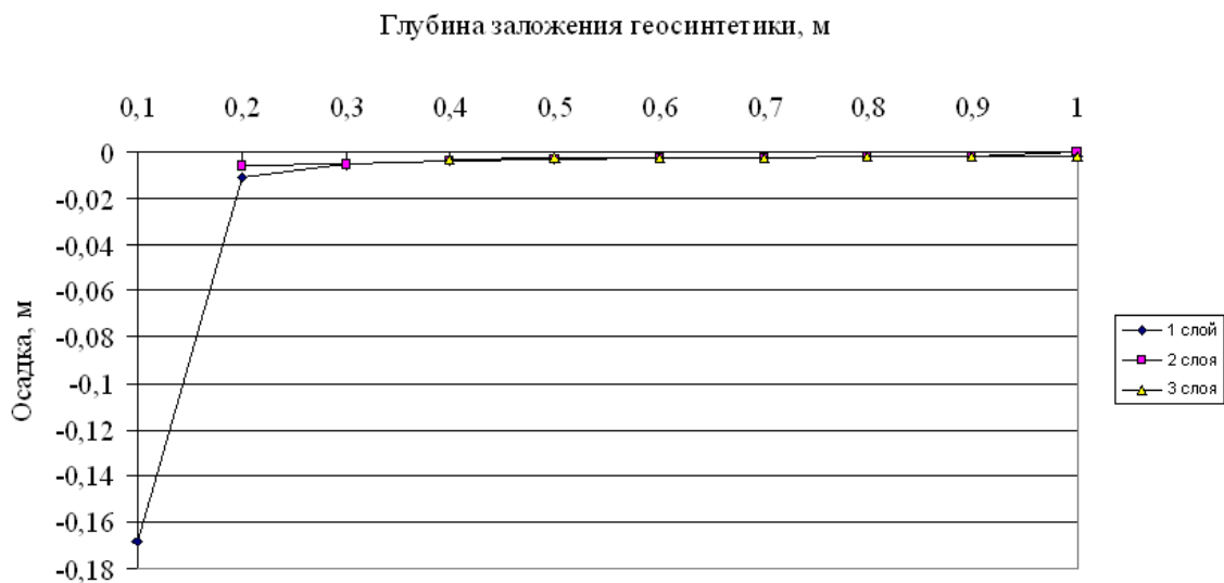
Рис. 4. Изменение осадки поверхности при провале грунта при отсутствии полезной нагрузки в зависимости от глубины заложения армирующих прослоек на примере модели грунта №10; нормальная жесткость геосинтетического материала 7000 кН/м
