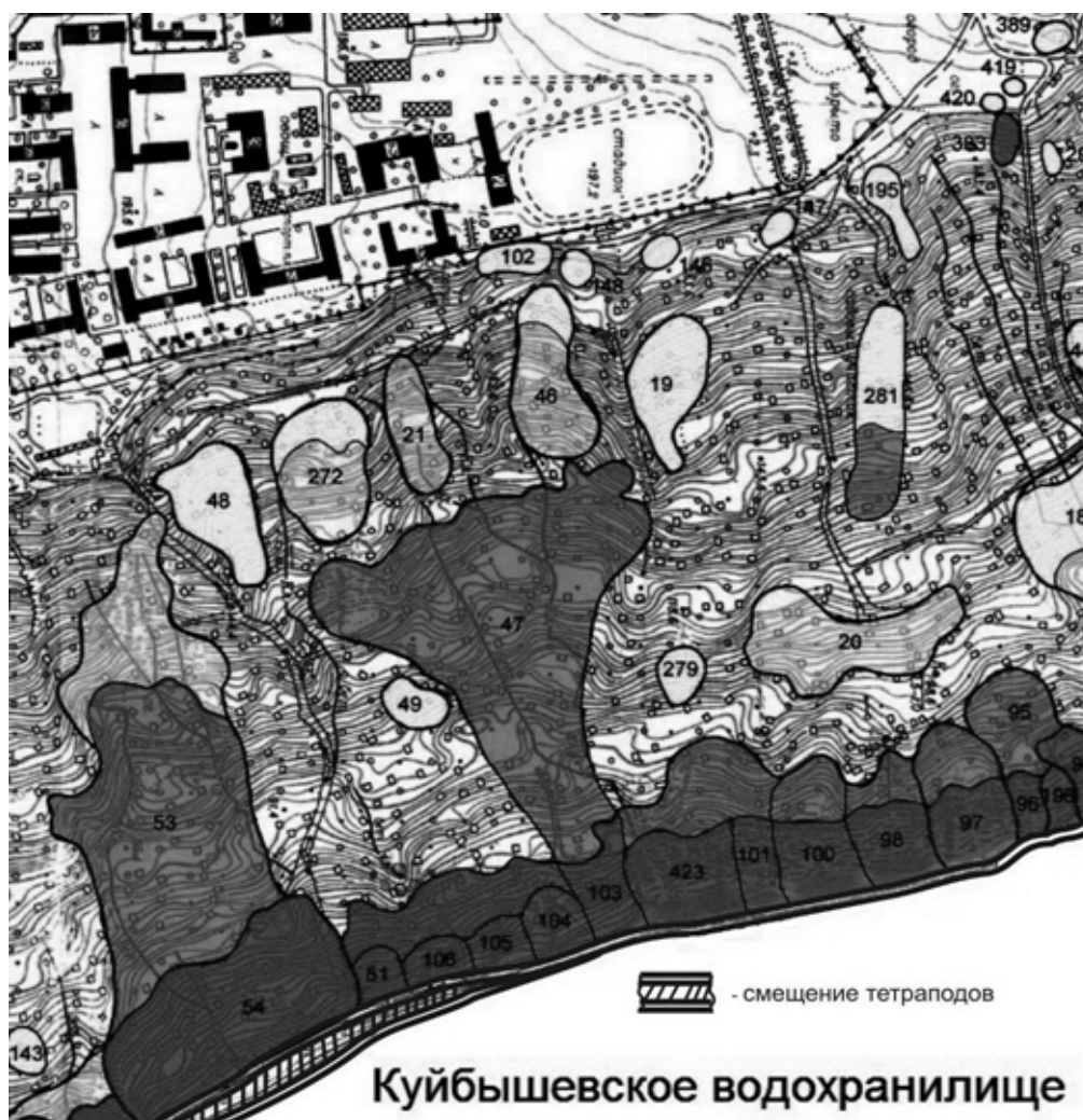
Рис. 2. Участок склона от ул. Тухачевского до ул. Новгородской с изображением картины смещений берегоукрепительных сооружений
