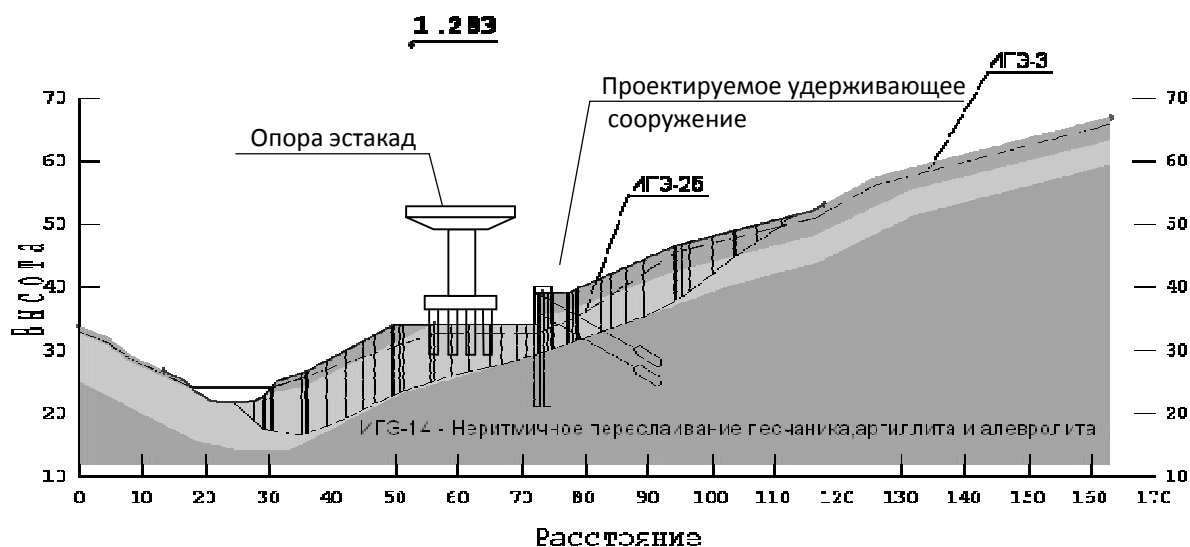
Рис. 3. Расчет устойчивости склона с учетом удерживающих конструкций (двухрядное свайное сооружение с усилением анкерными сваями)
