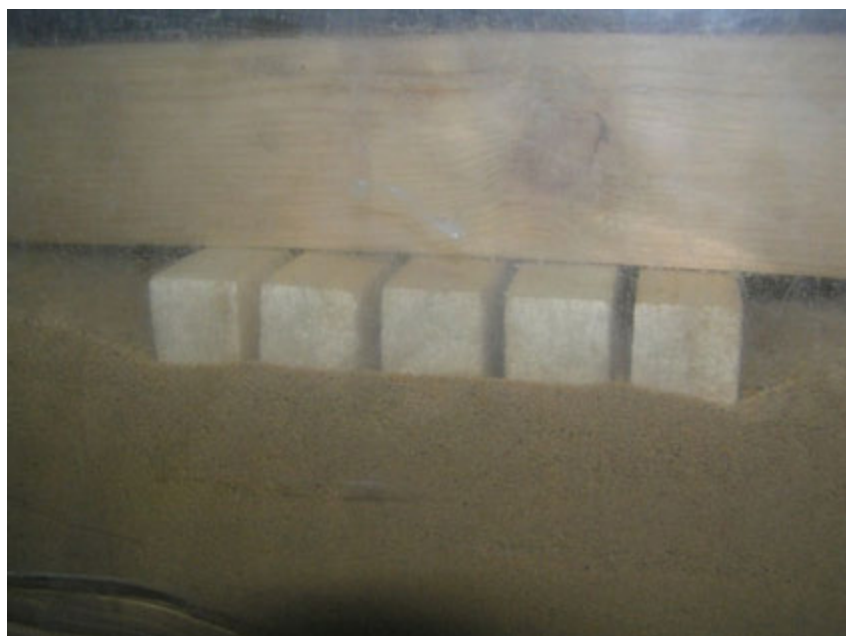
Рис. 4. Фотография модели системы фундаментов при \Delta d_2 = 4 мм в момент потери устойчивости основанием
