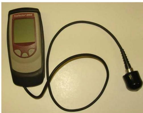
Рис. 1. Малогабаритный ультразвуковой прибор для определения толщины нанесенного разметочного материала (Позитектор 200).
