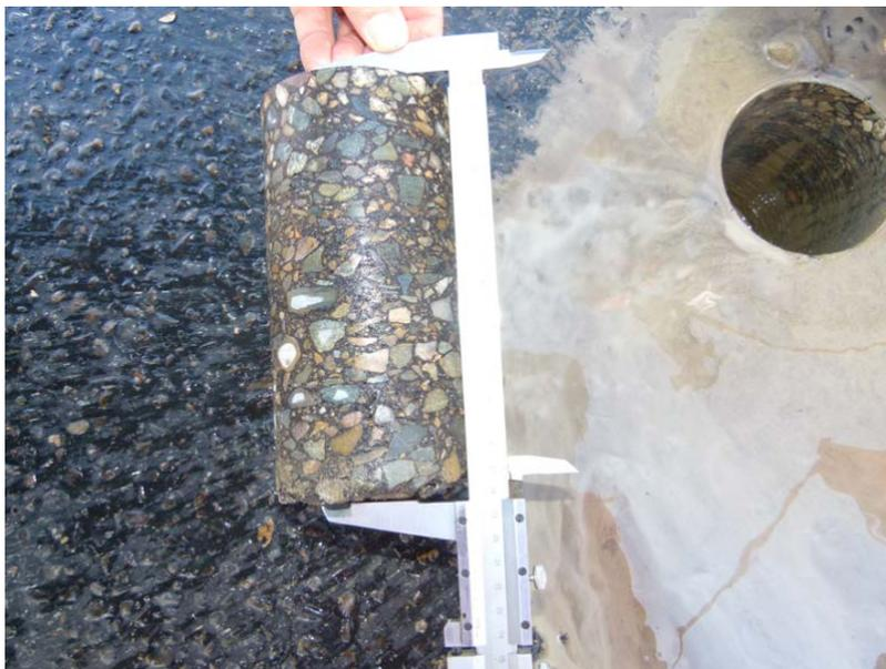
Рисунок 4 – Измерение размера керна образца материалов конструкции дорожной одежды.
