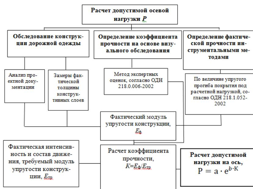
Рис.2 Блок-схема расчета допустимой осевой нагрузки.
