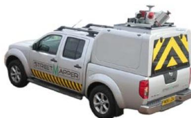
Рис. 3. Мобильный лазерный сканер StreetMapper 360 (со сканером RIEGL VQ-250) [6].
