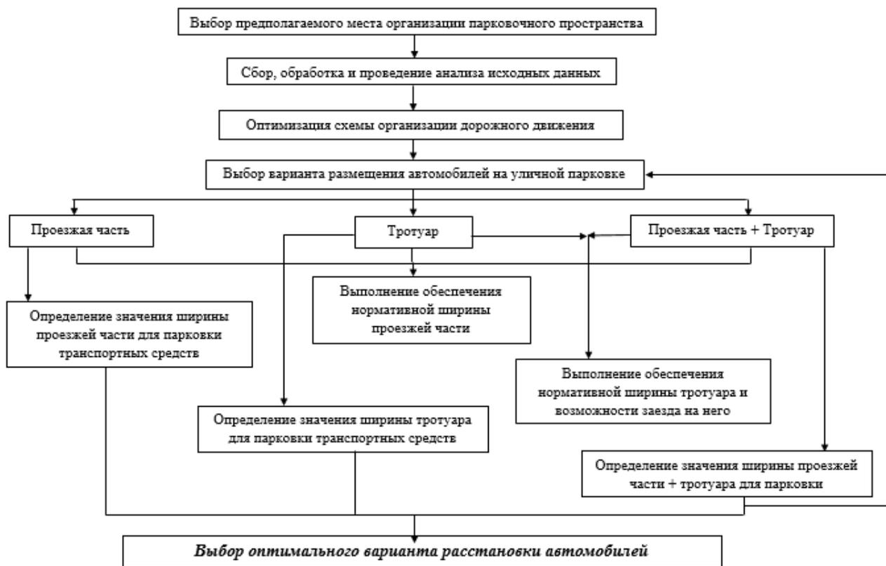
Рис. 4 – Алгоритм выбора варианта размещения автомобилей на уличной парковке.
