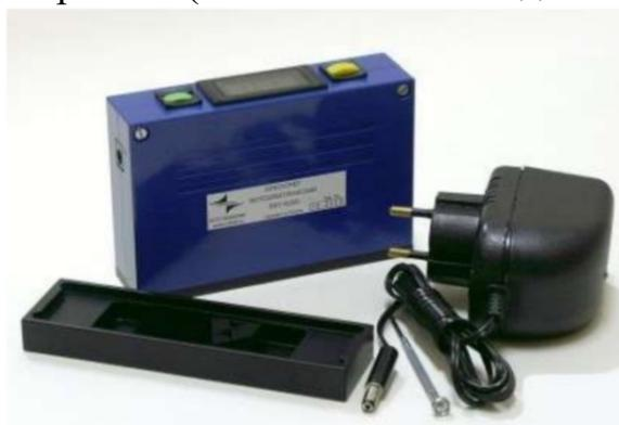
Рис. 2. Блескомер фотоэлектрический БФ5-45/0.
