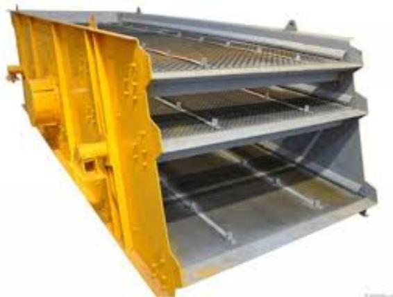
Рис.2 Агрегат вибрационного грохочения.
