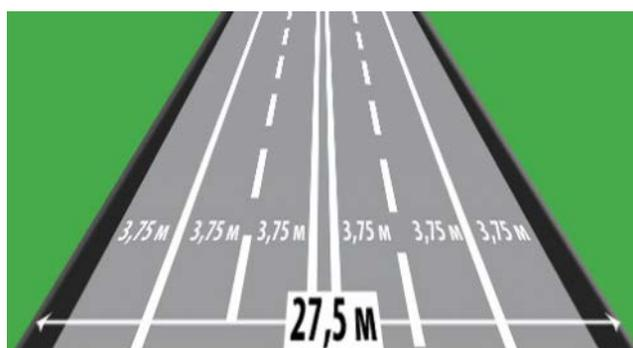
Рис. 3. Ширина дорожного полотна.
