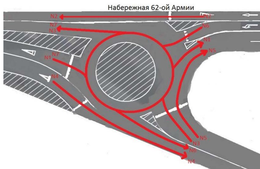
Рис 2. Схема распределения направлений движения транспортных потоков на пересечении 0-ой продольной магистрали и спуска от ул. маршала Чуйкова на Набережной 62-ой Армии.
