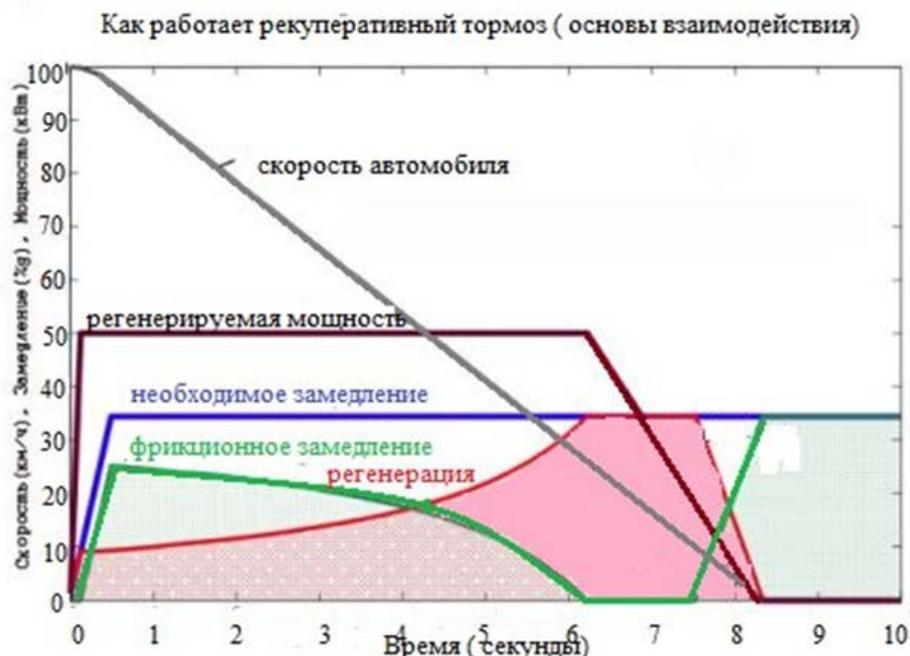
Рис. 4. Работа рекуперативного тормоза электромобилей.
