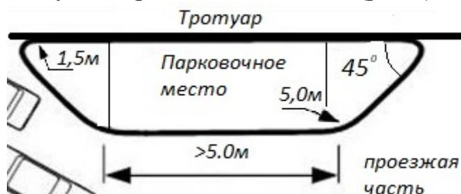
Рис. 4 Размеры трапецидального направляющего островка.
