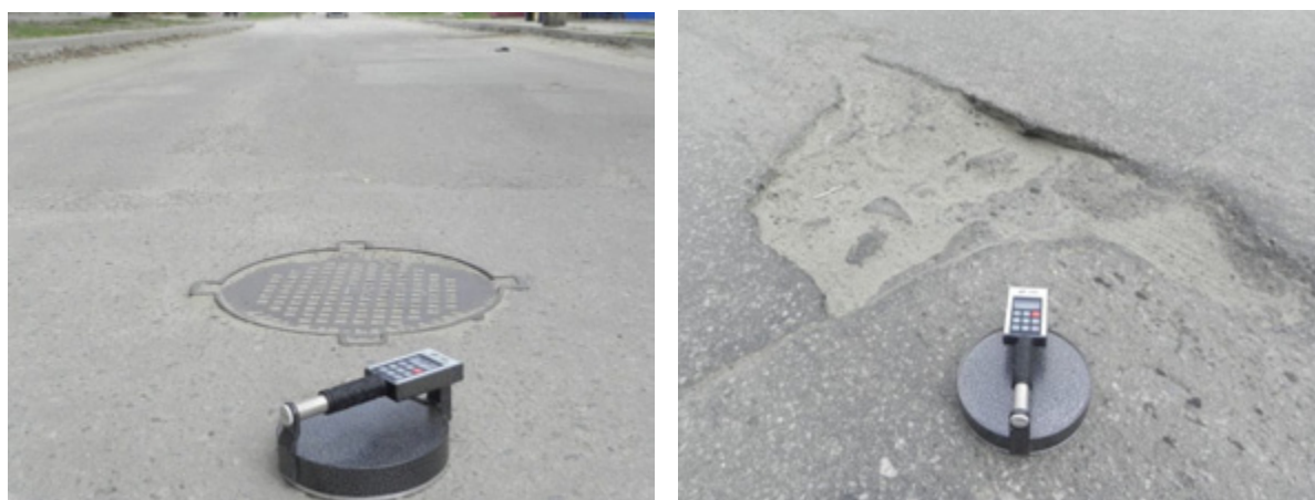
Рис. 1. Измерение плотности асфальтобетона около канализационных люков и выбоин
