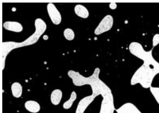
Рис. 2. Микроструктура композиций битума с 5% масс СКЭПТ-Э-30 при 200 и 25°C
