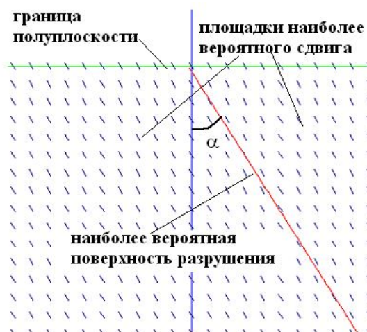
Рис. 14. Расчетная схема МТФКП для бесконечно толстого слоя грунта
