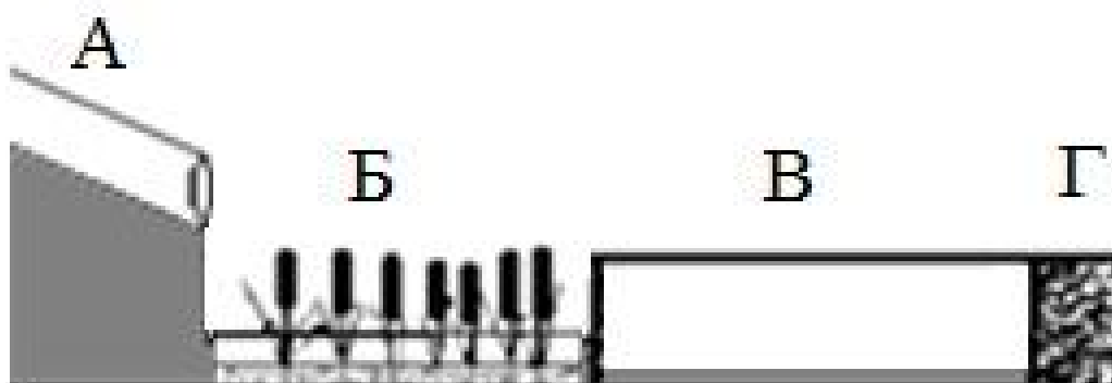
Рис. 1. Схема очистного сооружения ПЛС: А – водоподводящий лоток, Б – гидробиотаническая площадка, В – станция осветления, Г – фильтровальный блок
