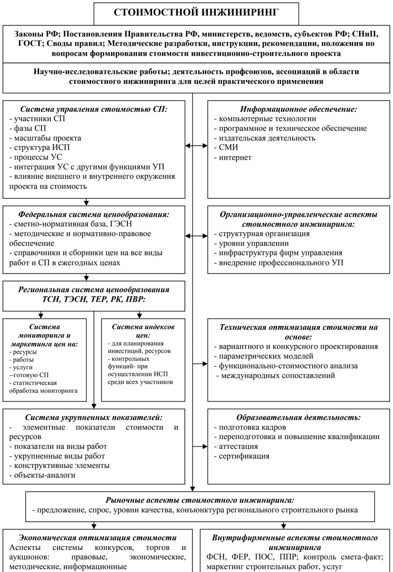
Рис. 1. Системная структура стоимостного инжиниринга
