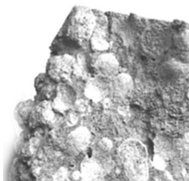
Рис. 1. Характер разрушения цементного бетона на основе крупного гранулированного безобжигового заполнителя на основе шлака после испытания образцов на сжатие
