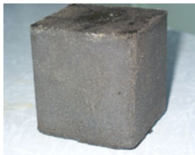
Рис. 1. Образцы-кубики из шлакосиликатного цемента, в форме и через 7 суток твердения
