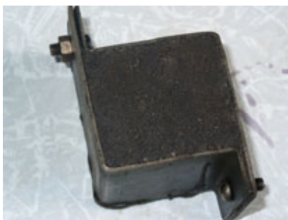
Рис. 1. Образцы-кубики из шлакосиликатного цемента, в форме и через 7 суток твердения
