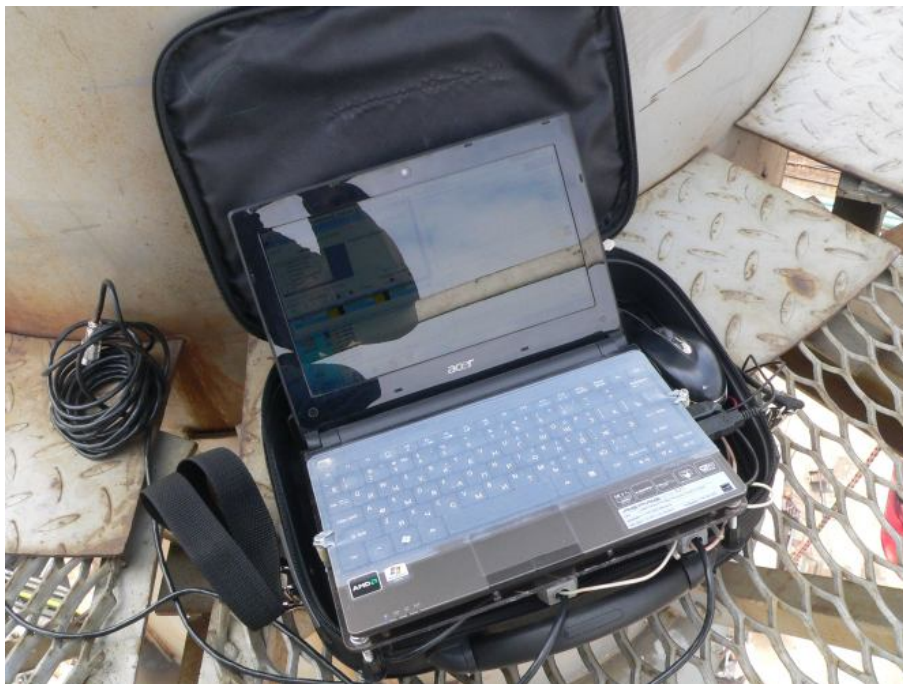
Фото 1. Портативный комплекс для измерения параметров колебаний строительных конструкций
