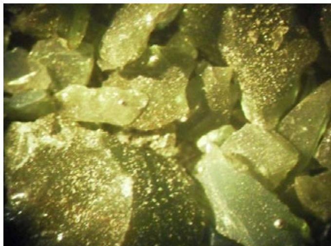
Рис. 1. Измельченный кусок отходов (шлака) производства ферросплавов (МБС-9, 40 х )
