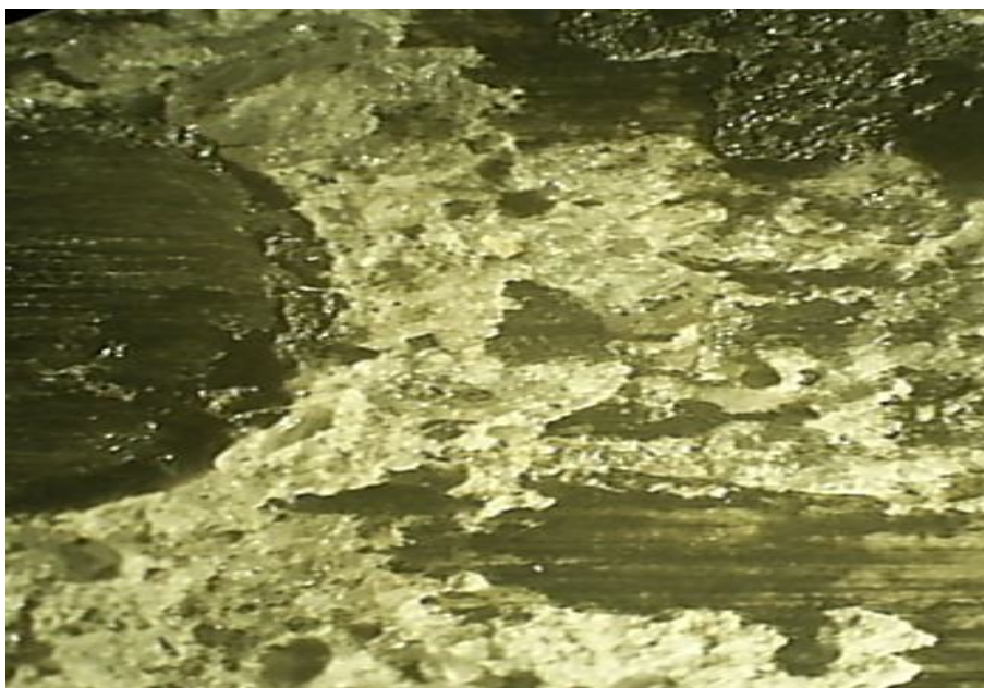
Рис. 1. Структура образцов бетона с заполнителем – металлургическим шлаком
