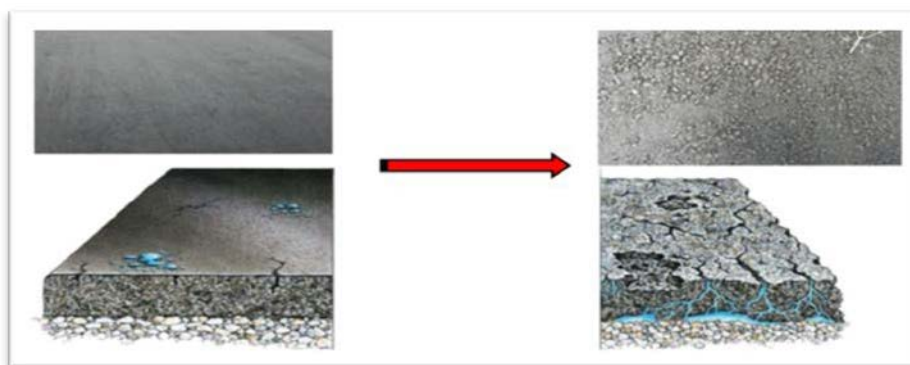
Рис. 3. Старение асфальтобетонного покрытия вследствие климатических условий.
