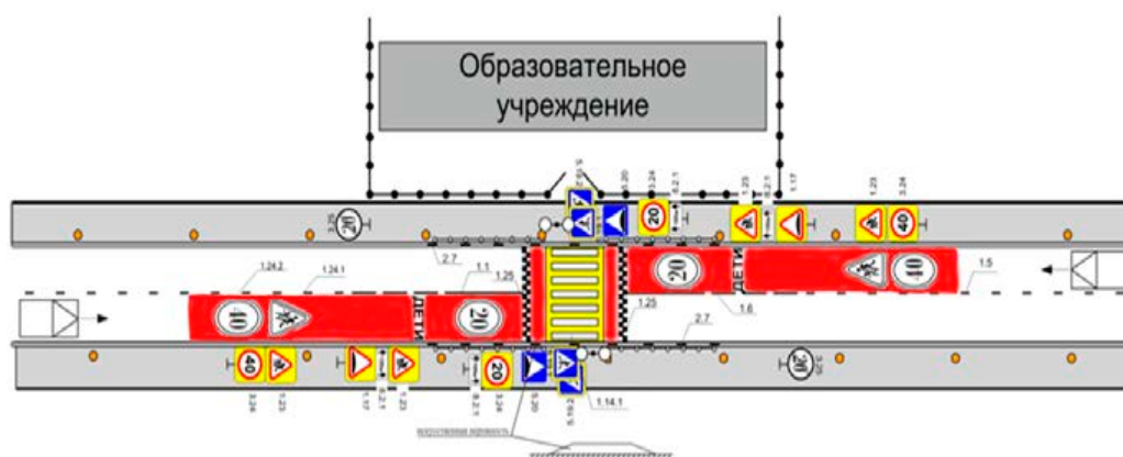
Рис. 4. Усовершенствованная схема размещения технических средств ОДД на подходах к образовательным учреждениям (цветовое зонирование, лазерные стены, светодиодные ка- тафоты).
