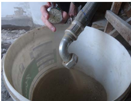
Рис. 2. Эксперимент по определению расхода песка при подаче под колесо автомобиля для устранения буксования.
