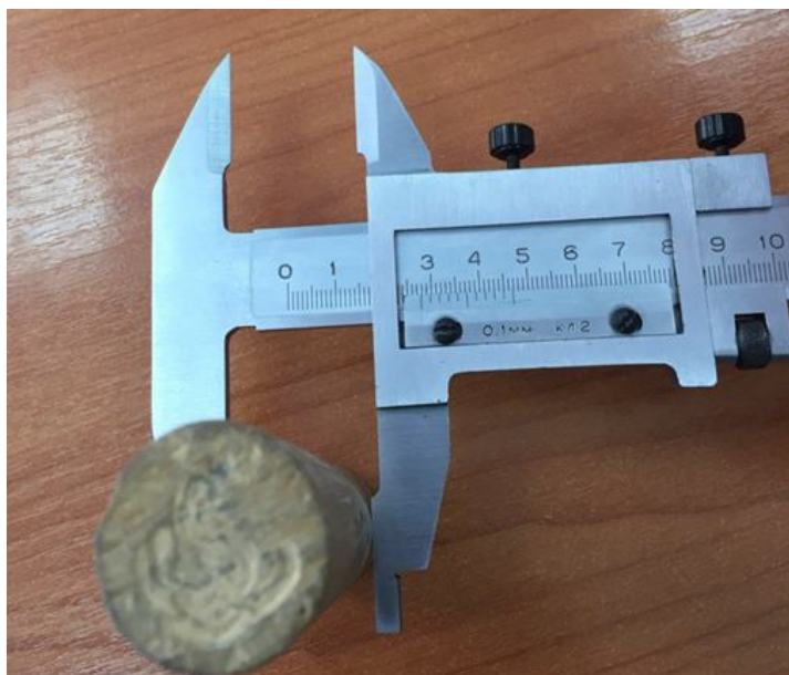
Рис. 2. Измерение диаметра цилиндра штангенциркулем в лабораторной работе «Измерение тела правильной геометрической формы»
