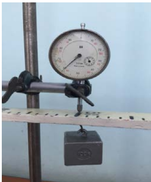
Рис. 1. Измерение стрелы прогиба деревянной балки в лабораторной работе «Изучение деформации деревянного бруса»
